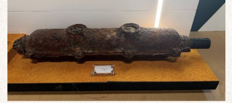
Cast Iron Joint موصل مصنوع من الحديد المصبوب، كان يستخدم سابقاً لتوصيل كابلات من الجهد المتوسط.
