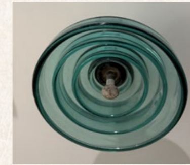
Disk insulator - Toughen glass عازل زجاجي لخطوط التوزيع الهوائية، تم استخدامه منذ عام 1980، وإستبداله بعوازل بورسلان.
